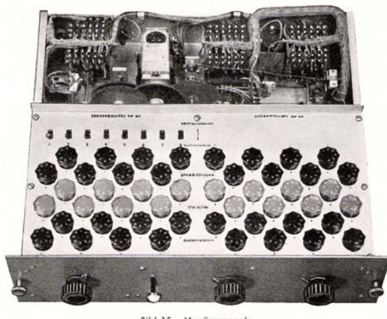
Manöverpanelen sedd uppifrån
