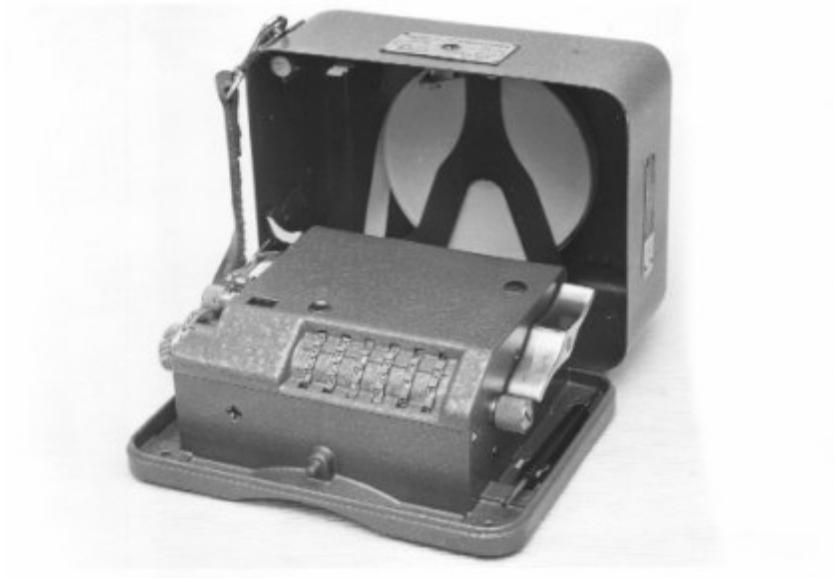
Chiffreringsapparat m/40 användes för lokal (off-line) chiffrering resp dechiffrering av meddelanden. Nyckelinställning skedde manuellt. Utskrift av chiffer- eller klartext skedde på pappersremsa. Chiffernycklar distribuerades av central instans.
