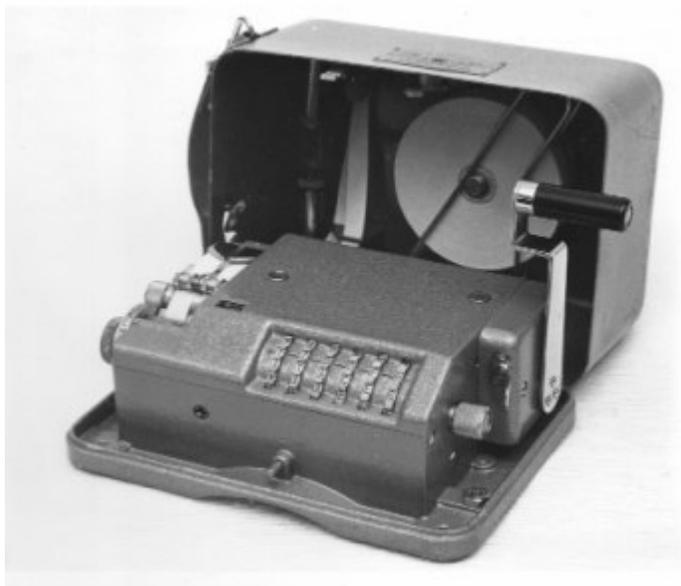
Chiffreringsapparat m/42 användes för lokal (off-line) chiffrering resp dechiffrering av meddelanden. Nyckelinställning skedde manuellt. Utskrift av både chiffer- och klartext skedde på pappersremsor. Chiffernycklar distribuerades av central instans.
