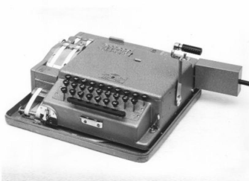
Chiffreringsapparat m/40 T användes för lokal (off-line) chiffrering resp dechiffrering av meddelanden. Nyckelinställning skedde manuellt. Apparaten var försedd med tangentbord och utskrift av chiffer- och klartext skedde på pappersremsor. Apparaten kunde drivas både manuellt och elektriskt. Chiffernycklar distribuerades av central instans.
