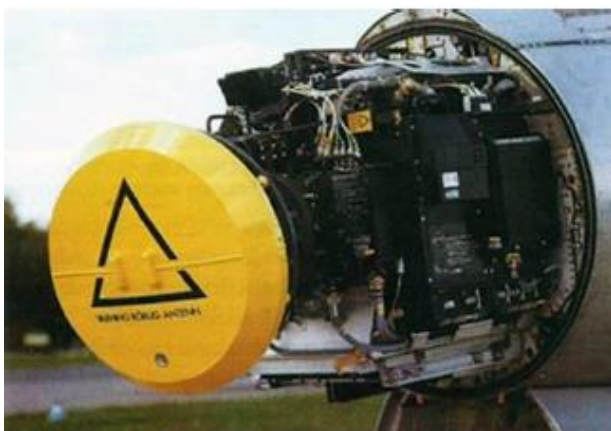
Radar PS-46/A för JA37. IK-antennen på radarantennen (Foto Ericsson Microwave Systems)
