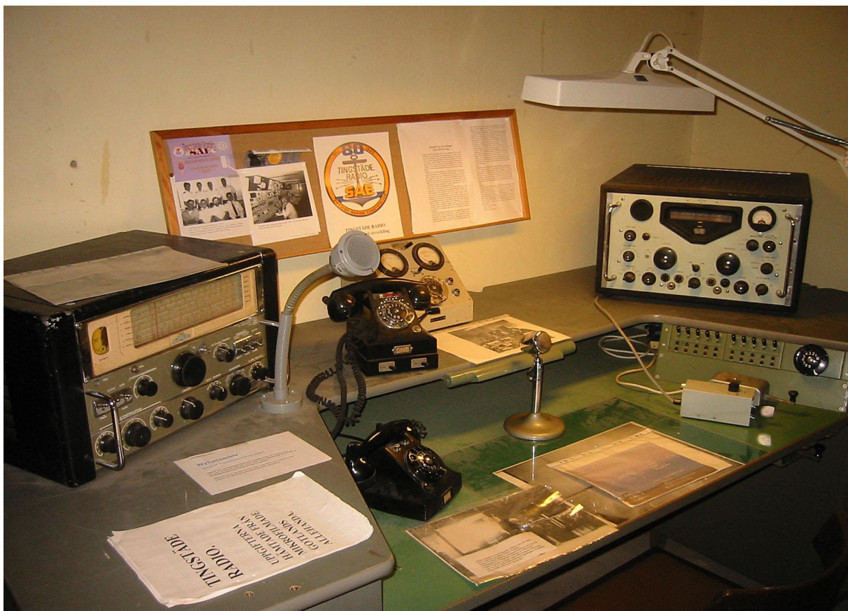
Typisk mottagarexpeditionsplats under 50- och 60-talet. Mottagare BRT till vänster och en Racal till höger. Foto: Arne Ahlström
