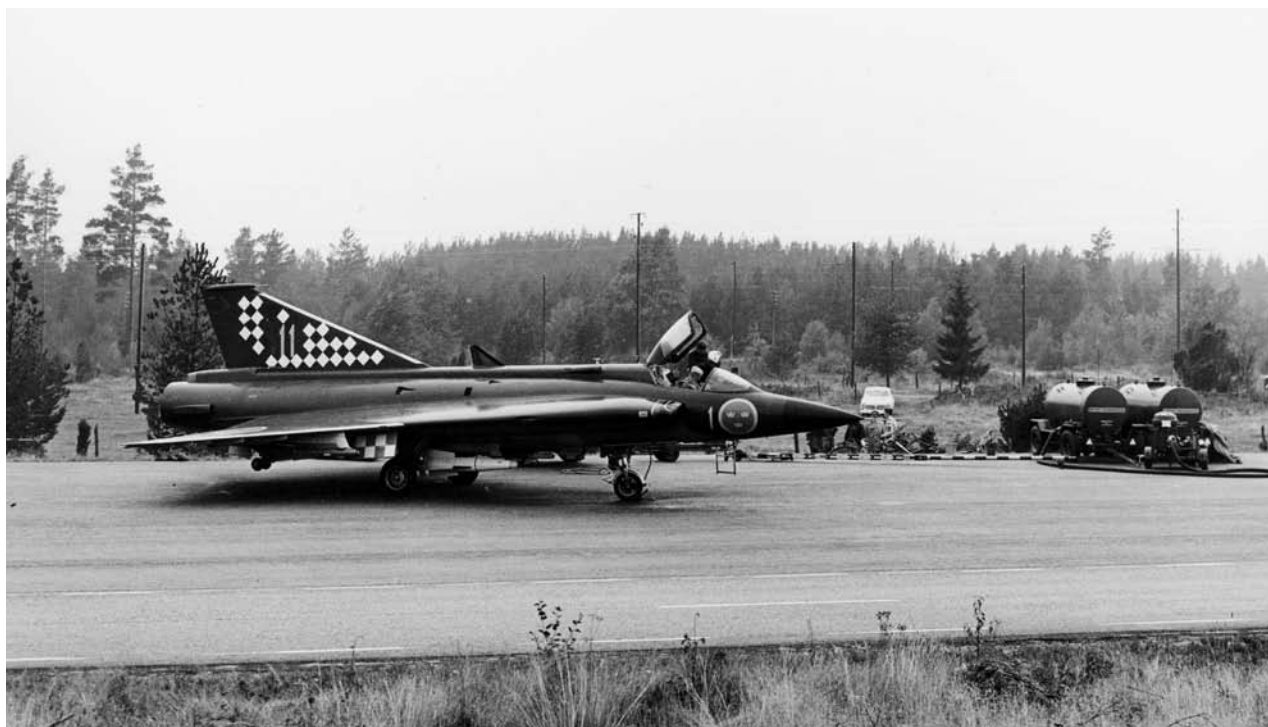
Bild 8. J 35 Draken från F 1 i Västerås uppställd på klargöringsficka vid reservvägbas. Rulltankar med bränsle och pumpaggregat för tankning. (Svensk Flyghistorisk Förening)
