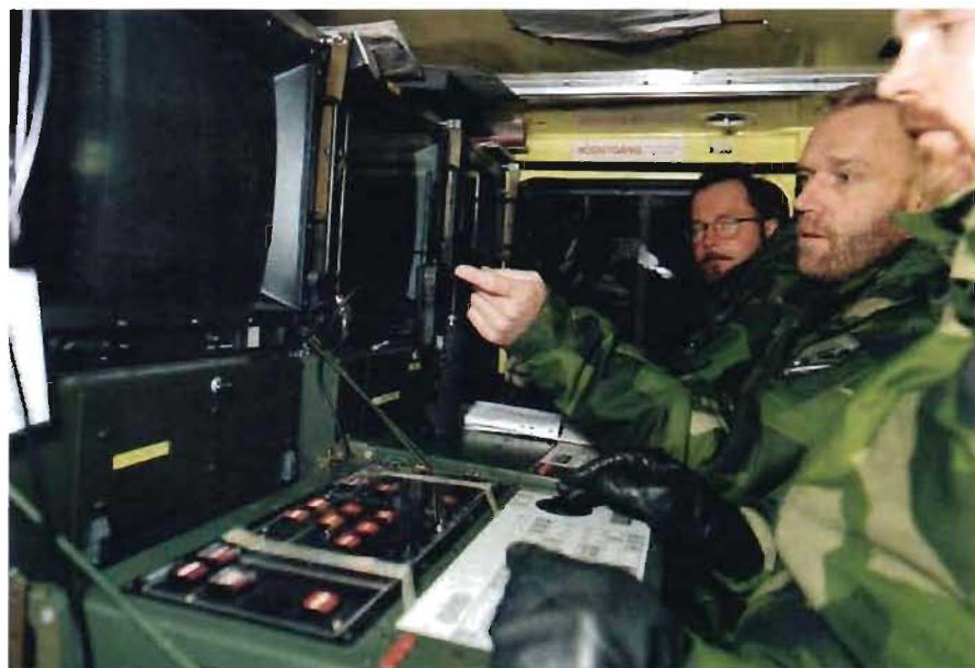
Den obemannade spaningsflygfarkosten Ugglan manövreras från en markstation. Flygrutten är förprogrammerad, men piloten kan också direktstyra farkosten från sin manöverpanel.
