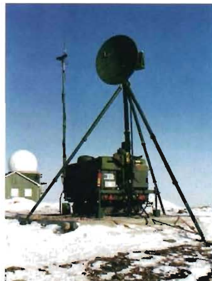
Den mobila länkstationen som vidarebefordrar sensor- och styrinformationen mellan markstationen och farkosten.
