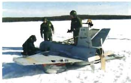
Ugglan landas med hjälp av en fallskärm. Här tas farkost och skärm om hand efter landning.
