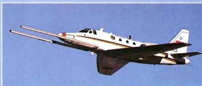
Den lågfrekventa markspaningsradarn Carabas flygutprovns i TP 86 Sabreliner.
