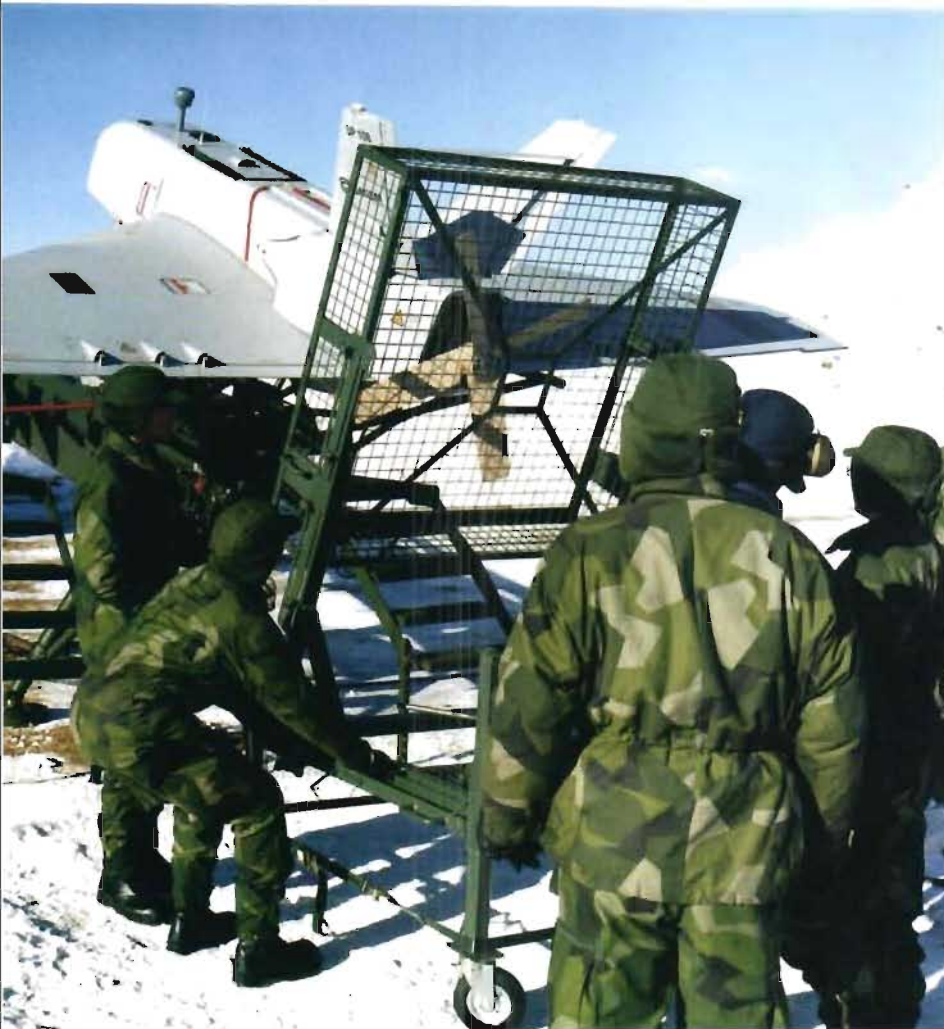
Ugglan startas med hjälp av en luftdriven katapult. Buren bakom farkosten är till för att skydda personalen från den roterande propellern.
