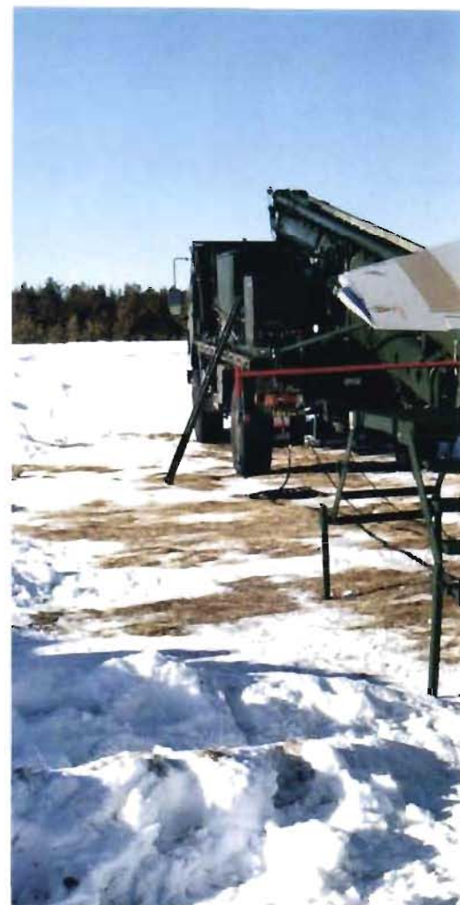
Den obemannade spaningsflygfarkosten Ugglan manövreras från en markstation. Flygrutten är förprogrammerad, men piloten kan också direktstyra farkosten från sin manöverpanel.
