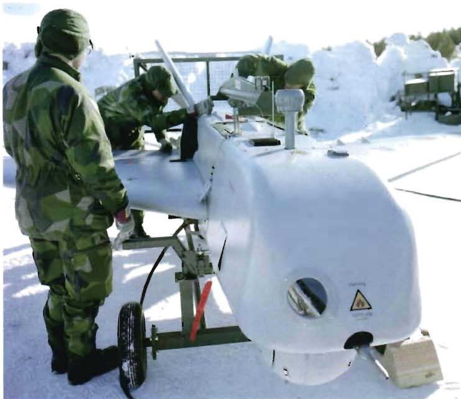
"Ögat" på Ugglans nosparti döljer en TV-kameralins.
