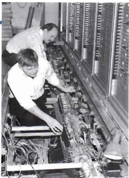
Byte av det centrala minnet i luftförsvarscentralen i Bålsta. På bilden från 1992 är Stig Lindgren och Lars-Erik Larsson i färd med att ersätta komponenterna från 1960-talet med modernare utrustning.
