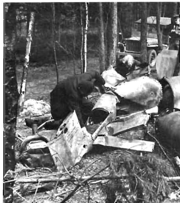
Hitlers första hemliga vapen — V 1:an. En flygplanliknande, självgående robot, en "flygande bomb". Maxfart ca 600–650 km/tim, medförd sprängladdning ca 1 ton, "skottvidd" (flygsträcka) ca 300 km. Insattes mot
