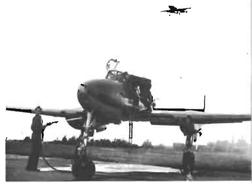
● Ovan: 1947 tillfördes F6 åter en SAAB-produkt, A 21:an — flygplanet med den "skjutande" propellern och världens första katapultstol. — Vid motorkörning på högre varv kopplades markkylväxelådan ur och spjällen öppnades, varvid vatten krävdes för kyning av motorn.
