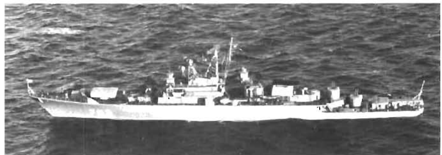
Ovan: Modern, sovjetisk robotjagare, typ 'Krivak'. Mycket omfattande vapenbestyckning; t ex: sjömåls- och luftmålsrobotar, antiubåtsraketer, torpeder, kanoner, m m.
