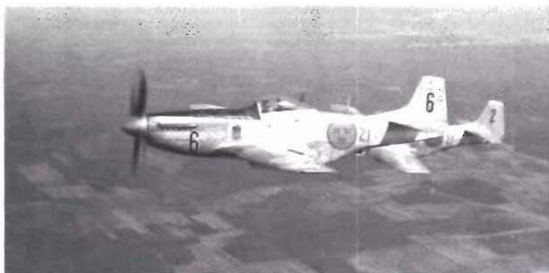
S 26 "Mustang" tillfördes spaningsdivisionen vid F21 vid dess uppsättande 1949. Det var som brukligt vid denna tid endast fråga om en enklare modifiering av ett jaktflygplan. I bagageutrymmet i bakkroppen på J 26 placerades en kamera för höghöjdsfotografering. Utrymmet var dock för litet, varför man byggde till det med en "bula" under kroppen.
