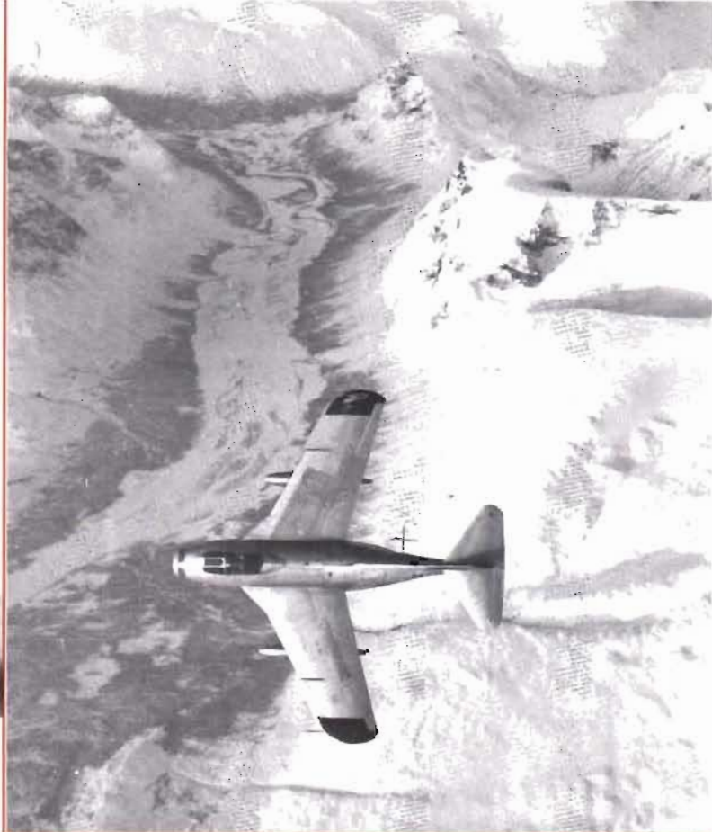
S 31/Supermarine "Spitfire" PR MK.19 anskaffades 1949 som ett kvalificerat spaningsflygplan för spaning från både hög och låg höjd. För första gången fick spaningsflyget tillgång till ett flygplan, som flög både snabbare och högre än motståndarna. Flygplanet var av denna anledning obebäpnat. Utrustningen bestod av moderna seriekameror.
