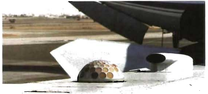
Ovan: På ryggsåsen på Su-24 MK FENCER D finns en robotskottsvarnare.
