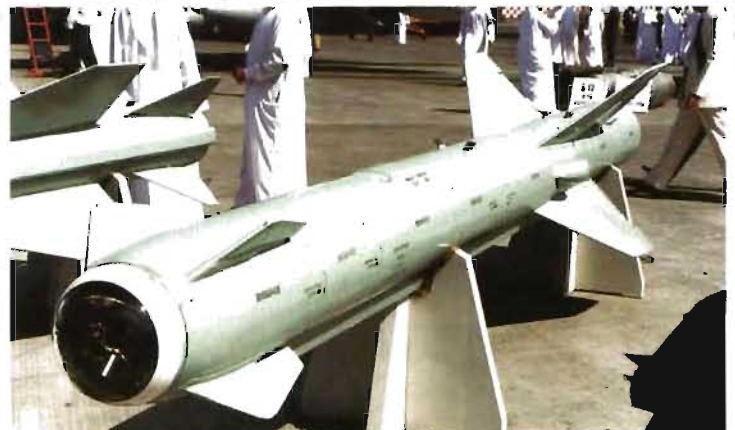
AS-13/Ch-59: TV-målsökande attackrobot för Su-24.
