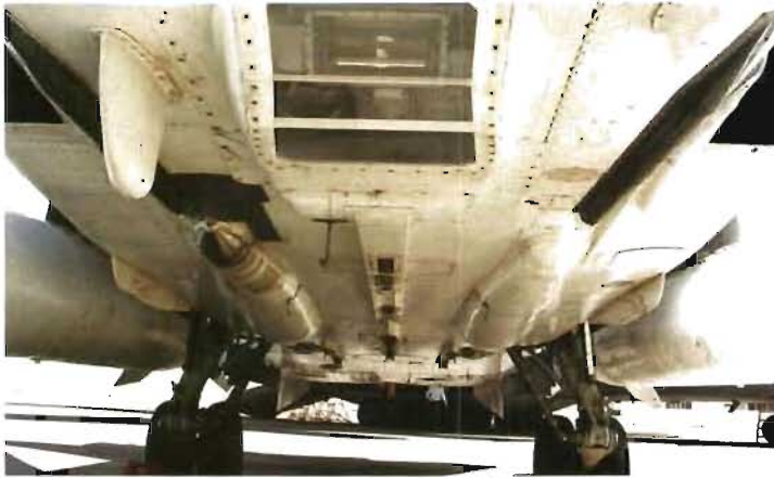
Su-24 MK (underifrån) har avancerad TV-utrustning + kombinerad laser-avståndsmätare/laserutpekare innanför glasbyggnaden. Där bakom i två långsmala utbuktningar (t v) 6-pipig 23mm akan av Gatlintyp + (t h) registrerkamera.
