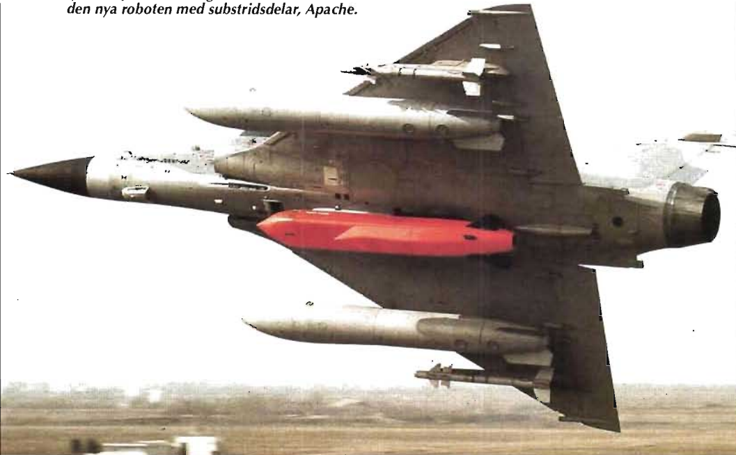
Franska Mirage 2000 här beväpnad med (ytterst) jaktrobot Magic 2, extratank + centralt den nya roboten med substridsdelar, Apache.
