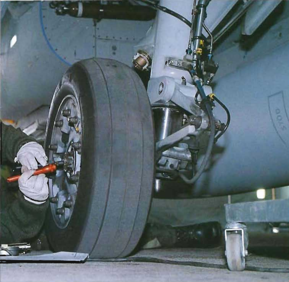
Löjtnant Malin Ekenberg från F 21 i Luleå inspekterar ett av hjulnaven under en s k C-service av JAS 39 Gripen. Hela serviceproceduren gjordes i en fälthangar på Färila-basen.
