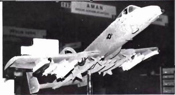
Ovan: Fairchild A-10 'Thunderbolt 2' med omfattande attacklast och två motmedelskaplar typ AN/ALQ-131 avsedda för elektronisk egen- och medstörning. (Bilden tagen under 'Paris-Salongen' 1979.) – T v: En 4-grupp A-10 med äldre typ av ECM-kapslar för med- och eskortstörning.
