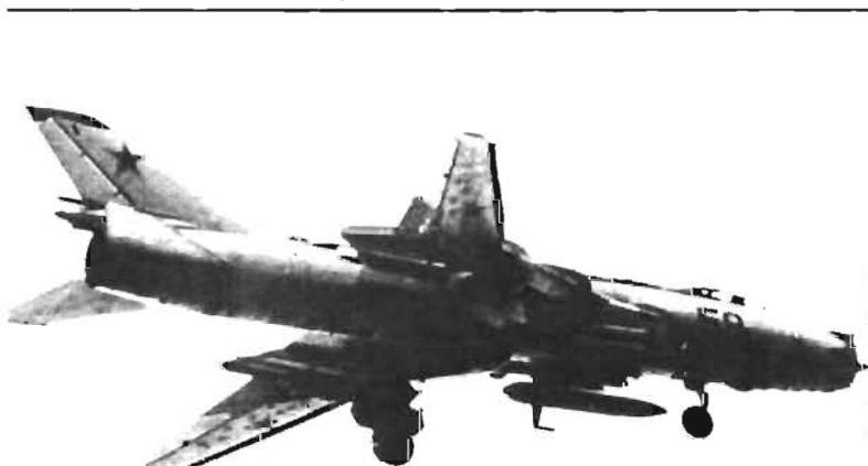
Sovjetiska Su-17 "FITTER C" utrustad med en motmedelskapsel, troligen avsedd för medstörning. Kapslar av den här typen kan sannolikt också flyttas över till andra flygplan. ▼
