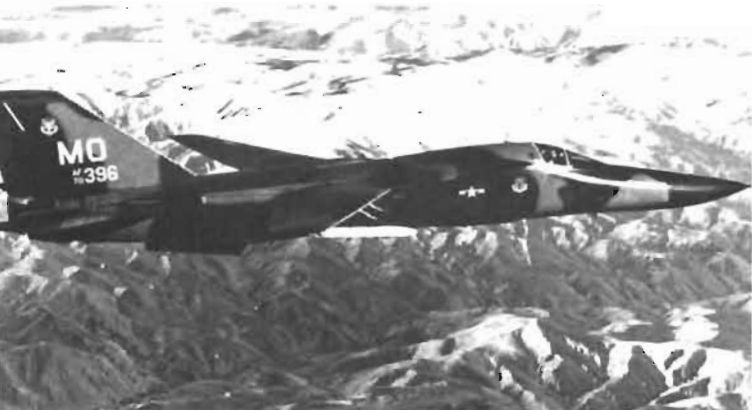
Ovan: Två TAC-flottiljer är utrustade med USAF:s mest avancerade attackflygplan F-111, som har terrängföljande radar och när överljudsfart även på lägsta höjd. — På 80-talet förses TAC med 42 motmedels-/stör(ECM)flygplan av typ EF-111A.
