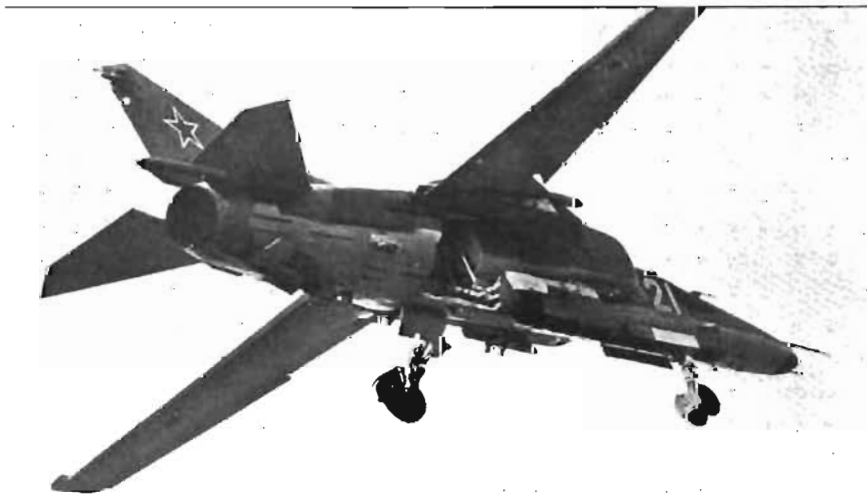
T v: De flesta offensiva flygplan är utrustade med bl a radarvarnare. På MiG-27 'FLOGGER D' sitter bakomvarnaren 'SIRENA' troligen i fentoppen.
