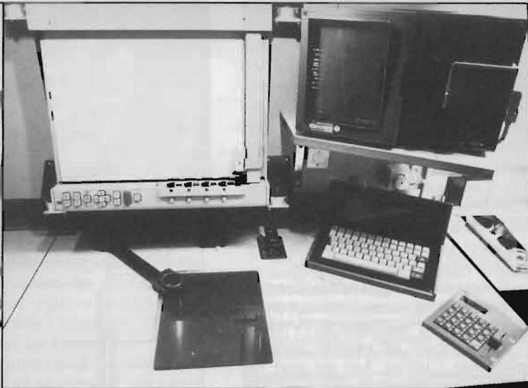
Bild 7: Radarbordet i närbild. Alla manöverorgan finns inom bekvämt räckhåll för tolken.
