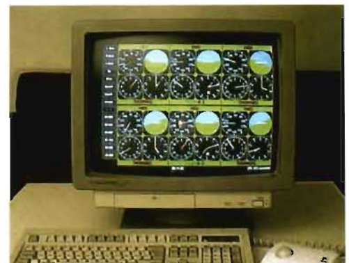
För att prova ledningssystemet och att träna trafikledare har man utvecklat en simulator. Simulatoren är speciell genom att en pilot kan styra upp till sex flygplan samtidigt. Detta innebär att mycket flygtrafik kan genereras med några få piloter. Simulatoren innehåller sex autopiloter, detta för att avlasta flygföraren.
