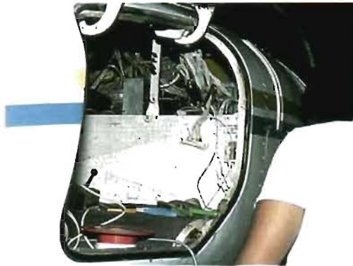
Flygplanet modifieras här så att styrdata kan överföras från satellitnavigering till styrautomat och HSI.
