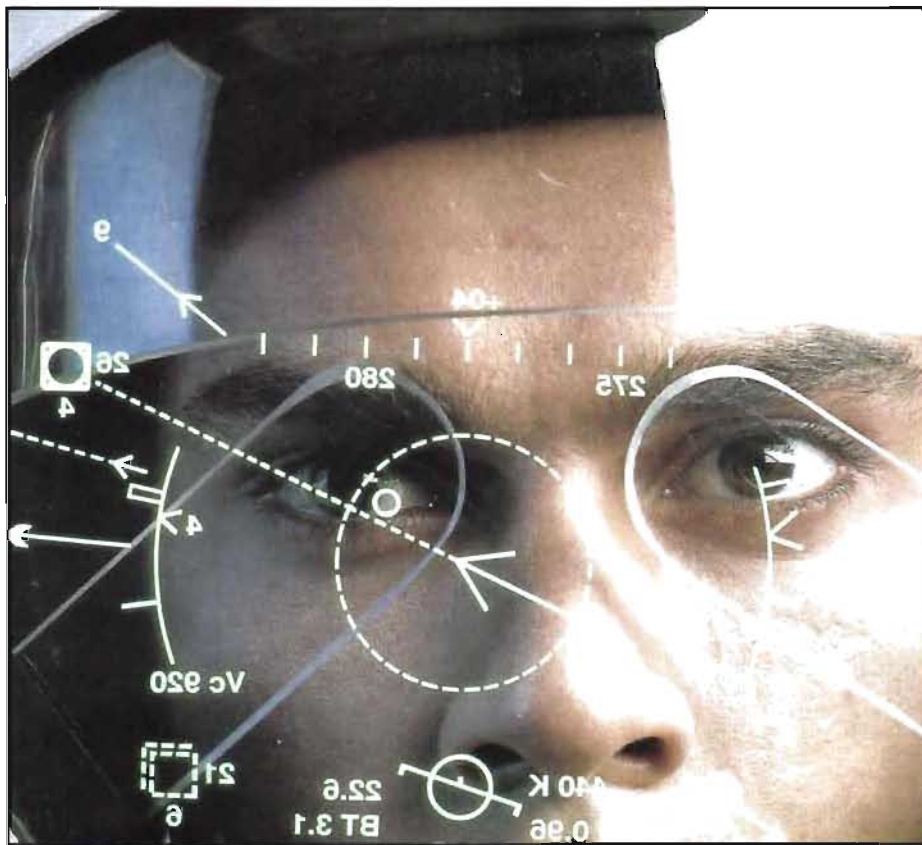
T v: Hjälmmonterat visuellt system – informationen visas på visiret.
