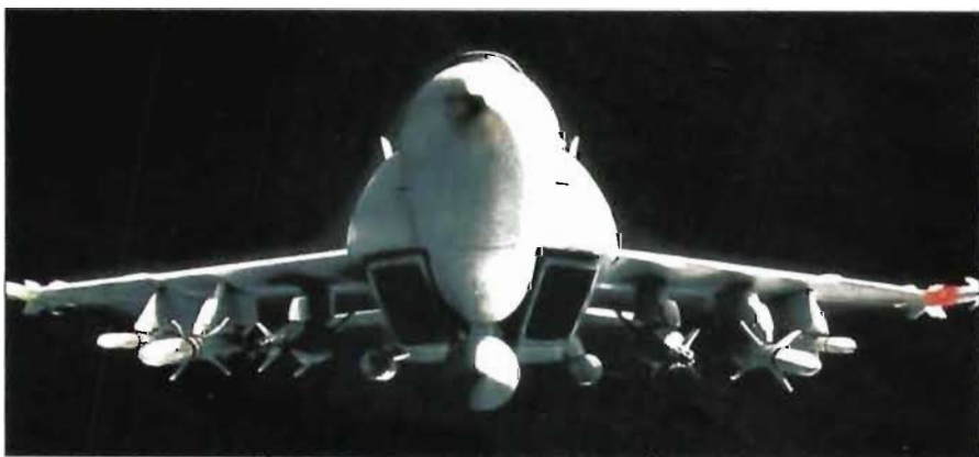
Modellbild av den närmaste versionen av Hornet = F/A-18 E/F. Nya motorgondolsinlopp + utökad vingframkantsarea. Bl a.
