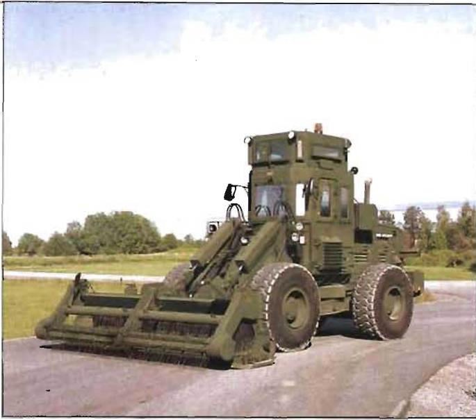
Det nya ammunitionsröjningsfordonet finns nu vid samtliga basbataljoner. Förarhytt och känsliga delar av fordonet är bepansrade. Fordonet används för röjning av bansystem och andra hårdgjorda ytor inom flygbasen.
