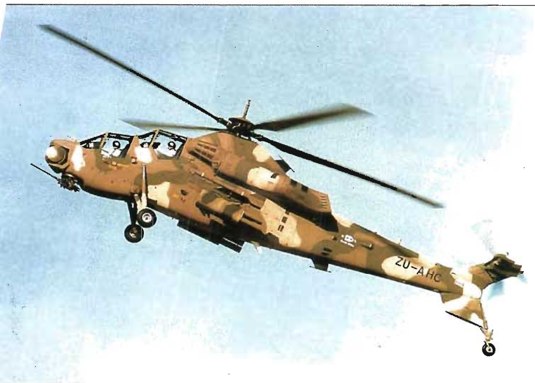
Sydafrikanska attackhelikoptern CSH-2 Rooivalk. Observera skydden för luftintagen och IR-dämparna vid motorutblåsen.
