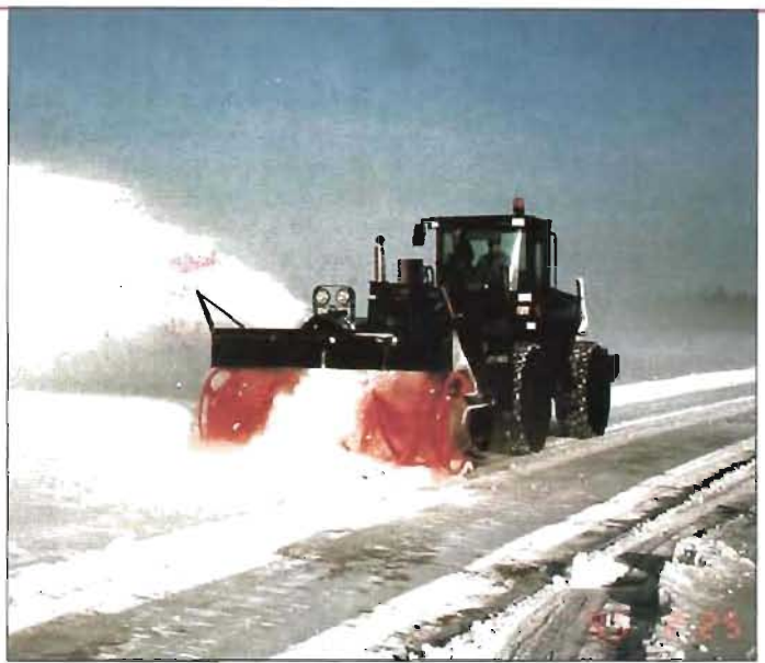
Utan en effektiv fälthållning skulle våra flygbaser snabbt bli omöjliga att använda. Vintertid är det viktigt att snabbt få undan snö och is. För snörjning används bl a denna nya typ av hjullastarburen snöslunga.
