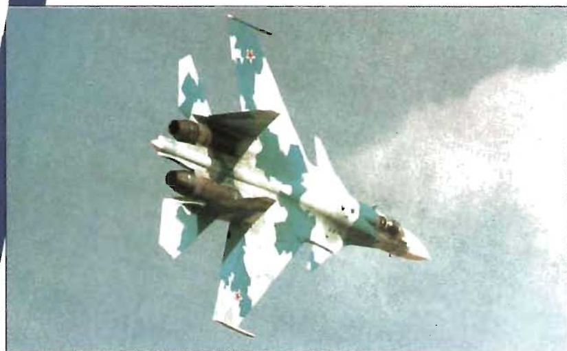
Ovan: Detta är Su-35 sedd "uppiifrån". Flygplanet har en bakåtriktad radar mellan motorutloppen.
