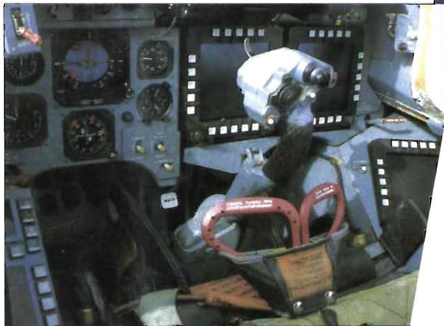
Delta är Su-35:ans cockpittlayout. Bl a ses de fyra monitorerna, som ger färgpresentation. I nedre vänstra hörnet ses den fjärde monitorn; ger troligen information i tabellform.
