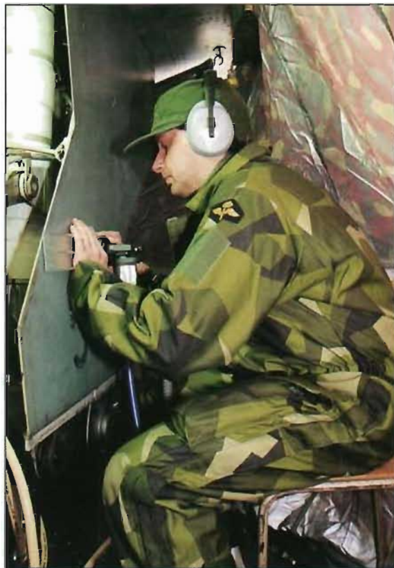
På bilden t h visas hur bearbetning av huvudställslucka på Viggen går till.
