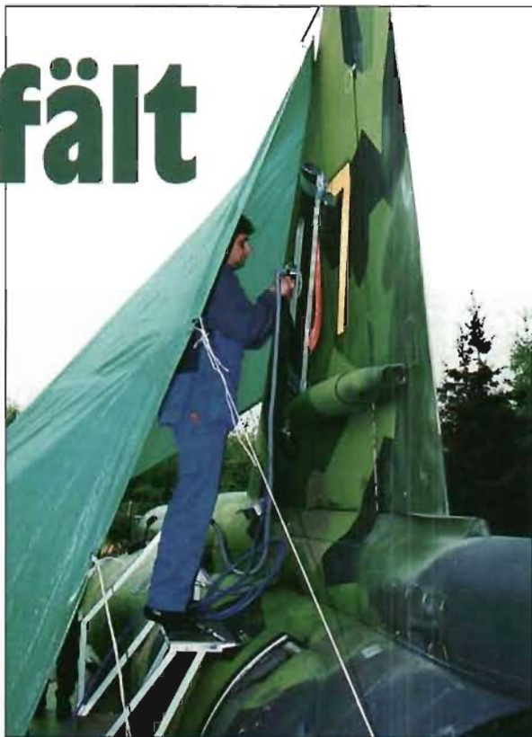
T v: Per Eliasson, Saab, utför en simulerad reparation på en Viggen-fena. Detta demonstrationsprov ägde rum under höstövningen 1995.
