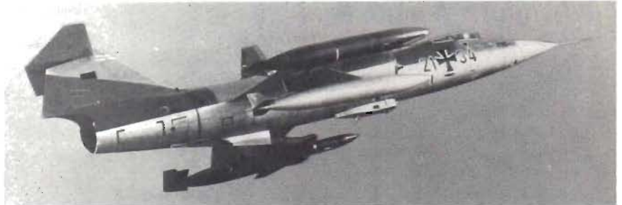
Licensbyggd Lockheed F-104G 'Starfighter' med attack-rb 'Komoran'.
