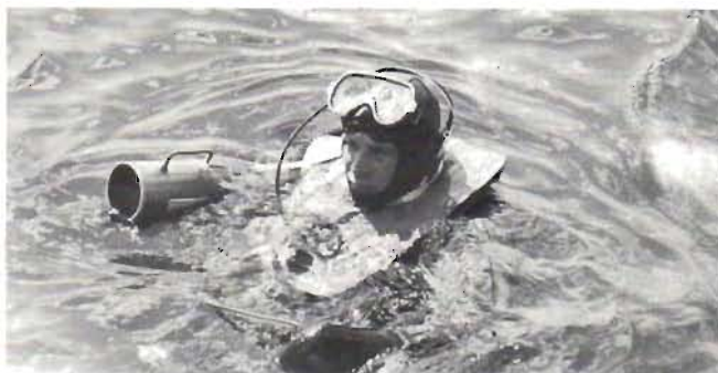
Överst & nedan: Dykhydrofonen – en speciell ljudavlysningsutrustning kan nyttjas såväl ovan som under vattenytan. – Ovan: Avlyssnarutrustningen komplett i sin väska.
