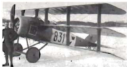
Triplanet 1917. Svensk konstruktion. Kallades "KjellPoKocken" pga Kjellson-konstruktör, von Porat-flygavd-chef, Kock- verkstadschef. Motor: Thulin 90 hk. — Fpi här med lt Nils Rodén.
