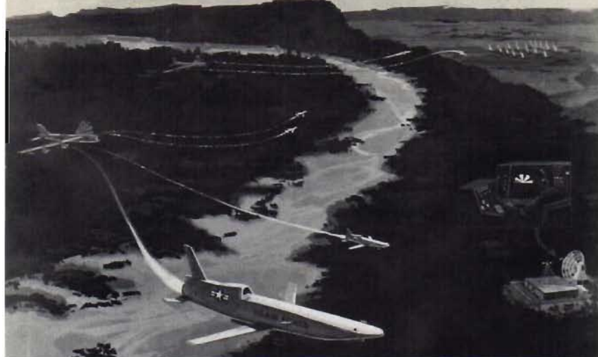
● USAF:s strategiska bomb-fpl B-52 kommer att förses med en ny robottyp: SCAD (-Subsonic Cruise Armed Decoy). Denna vanligtvis passiva rb avlyras från fpl mot 'fi' med radareko av en verklig B-52:a för att locka upp fi:s luftmåls-rb. Av de 4 avlyrade kan dock även 1-2 förses med stridsspets, vilket omöjliggör ett negligierande av rb:n.
