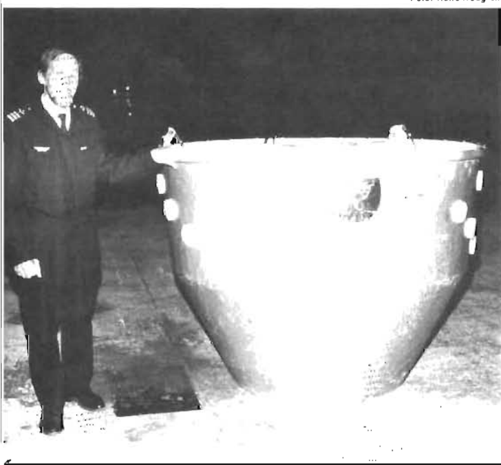
Nedan visar befälhavaren på "helikopterbombaren", kn Herman Pålsson/F17, det effektiva vattenämbaret. Del rymmer 1 800 l och hängs under hkp. Vattenpåfyllning sker genom nedsänkning i sjö. – 36 000 l i limmen vräktes ned över eldhavens mest utsatta områden. Foto: Rune Hedgren
