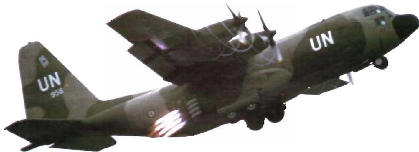
Norsk C-130 'Hercules' under spektakulär JATO-raketstart. Något för Sverige/våra TP 84/or?
