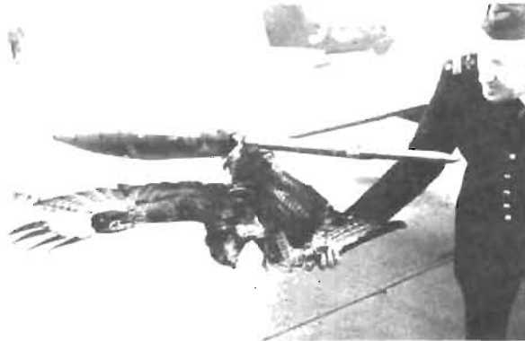
En rovfågel gick sitt öde till mötes vid konfrontation med en SK 60:s pilotrör. En relativt enkel skada. – Vårre är det då frontrutten eller motorinloppen träffas.
