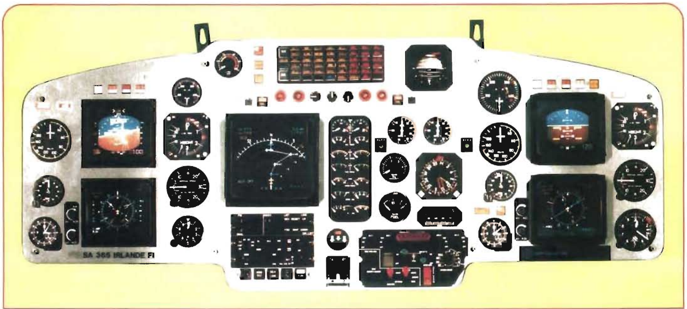
Bilden ovan visar en elektronisk instrumentering av ungefär samma utseende som den som HKP 10 Super Puma kommer att få. De fem elektroniska indikatorerna ger information från flyglägesgivare, navigeringsdator, radar samt checklista, m.m. Överlagring av radar och/eller navigeringsdata kan ske.
