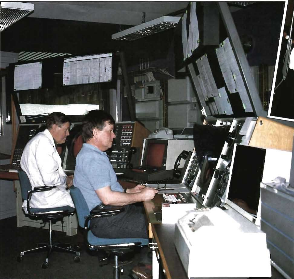
T v: TAST (= Trainer Anläggning STRIL). – När STRILS flyttade till Tullinge 1974 invides samtidigt den då hypermoderna simulatören – TAST. Denna har under åren successivt moderniserats och fungerar nu även som givare till rrgc/T. Elektroniken är i huvudsak från tidigt 70-tal. Den måste i dag betraktas som lite gammaldags, även om den löser sina uppgifter väl. Det börjar därför bli hög tid att besluta hur simulering för framtidens utbildning skall lösas.
