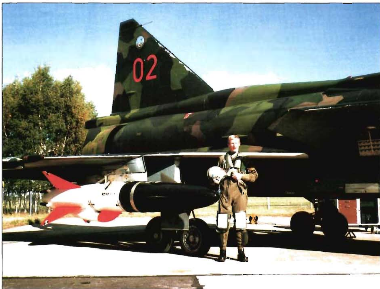
Sjömålsroboten RB 15F har i år börjat att levereras till FV från Saab Missiles AB. Roboten har under flera år flygutprovats vid FMV-PROV och då hängt under AJ 37 Viggen – vilken ju också kommer att kunna besjutas med denna ersattare till RB 04E.
