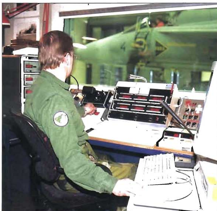
Motorkörledaren vid kontrollpanelen i motorprov- huset vid tekniska enheten.
