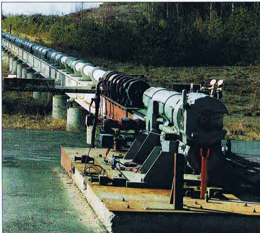
Ovan: "Sveriges snabbaste rörpost" har det skämtsamt sagts om denna "kanon" med vilken prov med eldrörsammunition görs.
