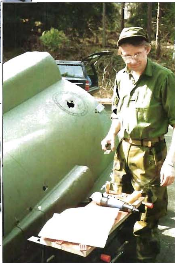
Det gäller att snabbt krigsreparera en skadad bakropp, den här tillhör Viggen. Flygtekniker Håkans beredd till aktion.
