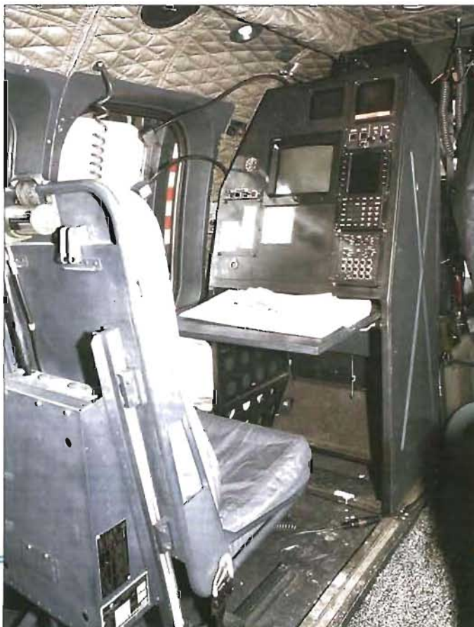
HKP 10:ans cockpit uppvisar största modernitet. Nu kan andre piloten bistå förste piloten helt, medan operatören sköter navigationen från en datapanel med kommunikationstabla, radar och inprogrammerad kartbild och färdlinje.
