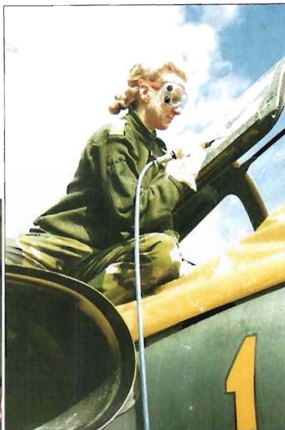
En genomskjuten huv vällar inga problem för Lotta Gandel. Epoxy och glasfibrer fyller skothålet i Drakens huvglas.
