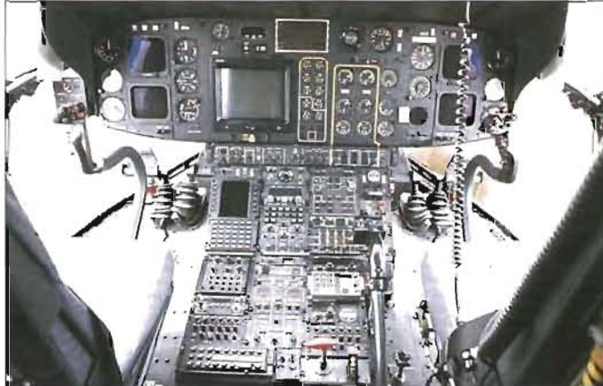
HKP 10:ans cockpit uppvisar största modernitet. Nu kan andre piloten bistå förste piloten helt, medan operatören sköter navigationen från en datapanel med kommunikationstabla, radar och inprogrammerad kartbild och färdlinje.
