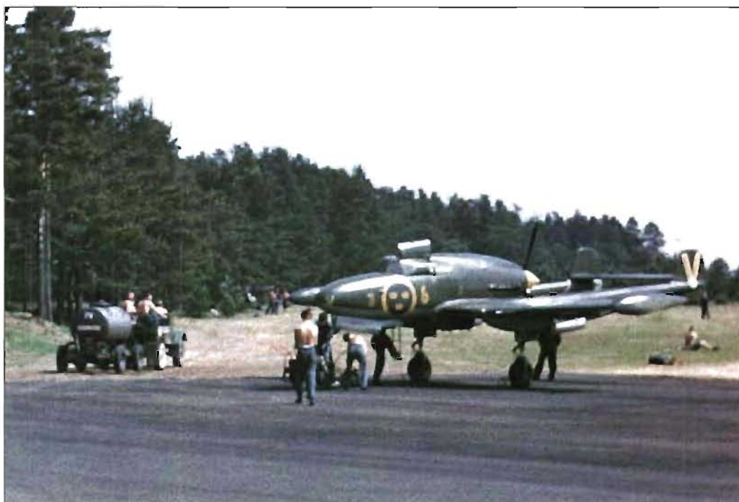
T h: Saab J 21 kallades "fullträffen med två bommar". Den fanns också (se bilden) i attackutförande, A 21. Planet är det enda exemplet i flyghistorien på en lyckad konvertering från propeller till readrift; J 21R. Skälet för den unika konfigurationen var att kompensera i jämförelse med utländska jaktflygplan sämre motorprestanda genom att koncentrera beväpningen till nosen och att ge piloten bättre sikt.
