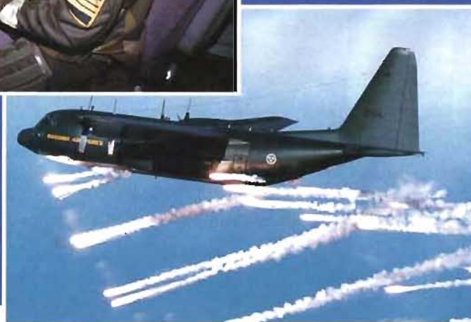
Ovan: I krigszon. För att störa ut eventuella värme-sökande robotar används avledande motmedel i form av utskjutning av facklor.
