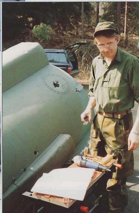
Det gäller att snabbt krigsreparera en skadad bakkropp, den här tillhör Viggen. Flygtekniker Håkans beredd till action.
