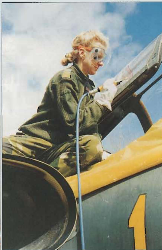
En genomskjuten huv vällar inga problem för Lotta Gandel. Epoxy och glasmikrobalonger fyller skotthålet i Drakens huvglas.
