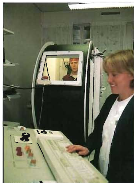
I minitryckkammaren mäts öronets tryckutjämningsförmåga.
