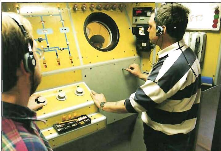
Ovan: FFO (flygfysiologiofficeren) har både visuell och radiokontakt med de inne i tryckkammaren. Operatören (t v) reglerar "vistelsehöjderna".
