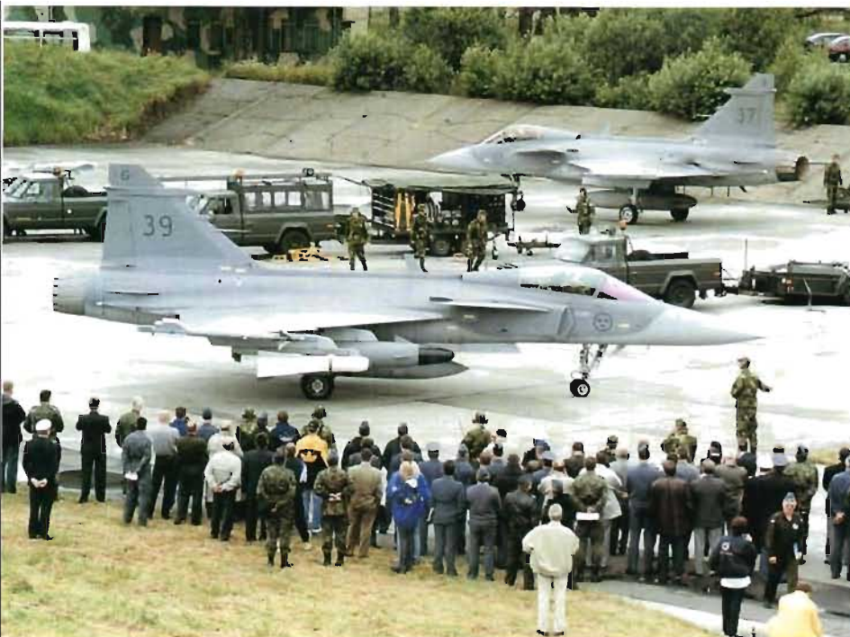
Två JAS 39 Gripen taxar in på Swidwin-flygbasen i norra Polen efter fullgjort uppdrag. Planet närmast är beväpnat med sjömålsroboten RB 15, märkmålsroboten RB 75 Maverick samt, långts ut på vingspetsen, jaktroboten RB 74 Sidewinder. Foto: Grzegorz Holdanowicz/Altair
