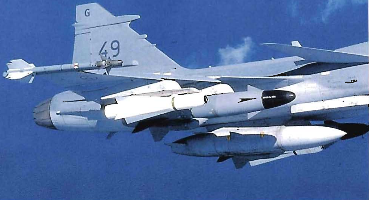
Det finns ett flertal olika beväpningsalternativ till JAS 39 Gripen. Detta plan är utrustat med sjömålsroboten RB 15, markmålsroboten RB 75 Maverick och luftförsvarsroboten RB 74.
