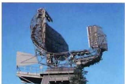
Höghöjdsradarsystemet PS-66 bevakade det svenska luftrumets högre nivåer.
