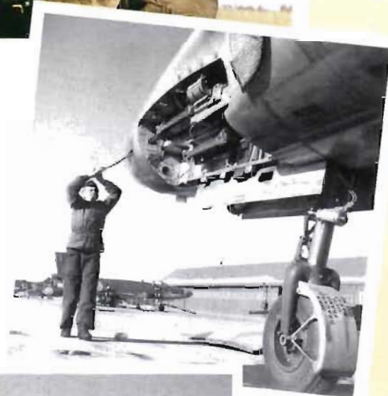
Lansens spaningsversion S 32C hade nosen fylld med kameror som gav bilder av hög kvalitet.
