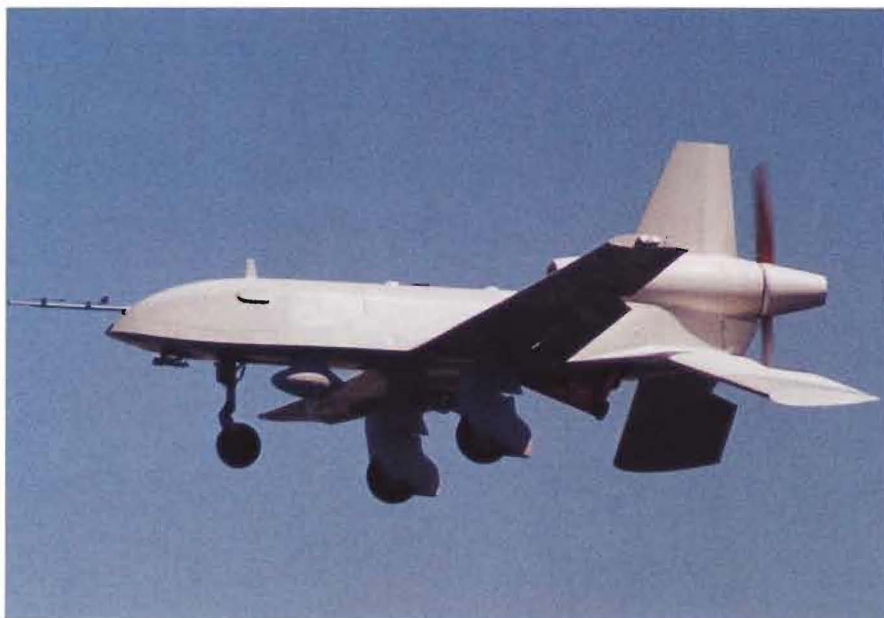
Flera typer av UAV är under utveckling. Detta är en Prowler II Tactical UAV, som har en aktionstid på över 18 timmar. Foto: GAAS
