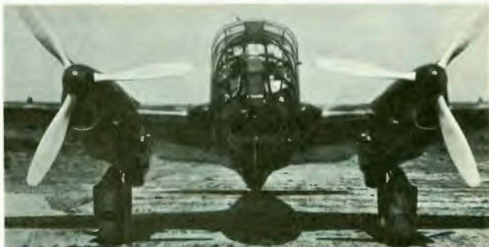
CAPRONI CA 313-monoplan — köpta i 1940 års nödläge från Italien, försedda med två 700 hk luftkylda, inverterade V-motorer typ Isotta-Fraschini Delta. Avsedda som bomb-, spanings- och torpedflygplan. Av det nära nittotal som anskaffades havererade ett flertal p g a fabriktionsfel. De sista "överlevande" Caproni-planen "förbrukades" såsom mål på marken vid en stor övning i stridskjutning 1945.
