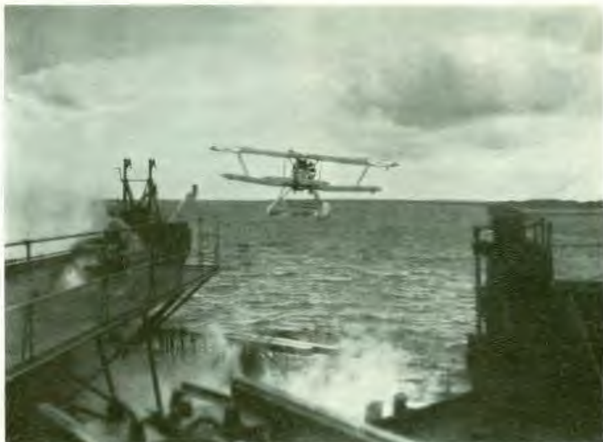
HAWKER OSPREY eller S9 — ett i följd av 1925 års försvarsbeslut anskaffat engelskt-byggt eldlednings- och spaningsplan till "flygplan-kryssaren" GOTLAND. Fanns tiden 1933—46 blott i ett fåtal exemplar. År 1944 hade antalet nedgått till fyra. Motor en Mercury IV A på 545 hk — toppfart ca 230 km/tim.
