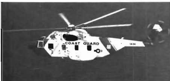
Ovan: Sikorsky S-61R/HH-3F 'Pelican' används för kvalificerade räddningsuppdrag. 2-motorig, 5 mans besättning.
