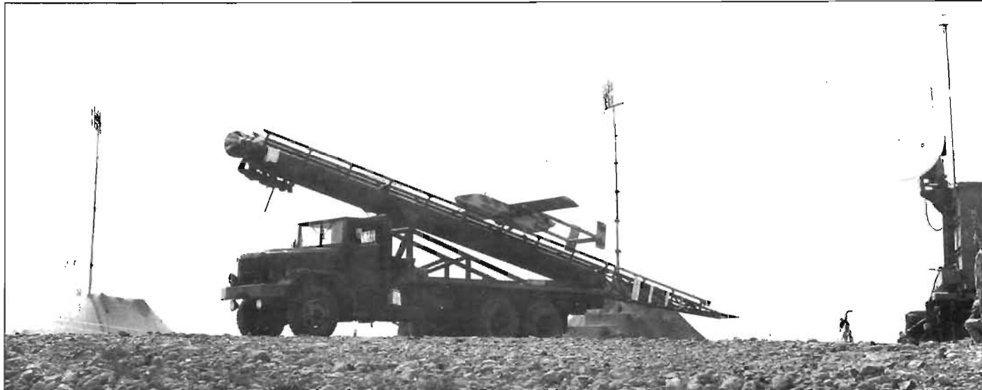
Ovan: RPV:n skjuts iväg med hjälp av tryckluftskatapult från en starttramp. Därefter leds miniatyrflygplanet från den likaledes mobila markstationen mot det förbestämda spanings- (mots) målet.
