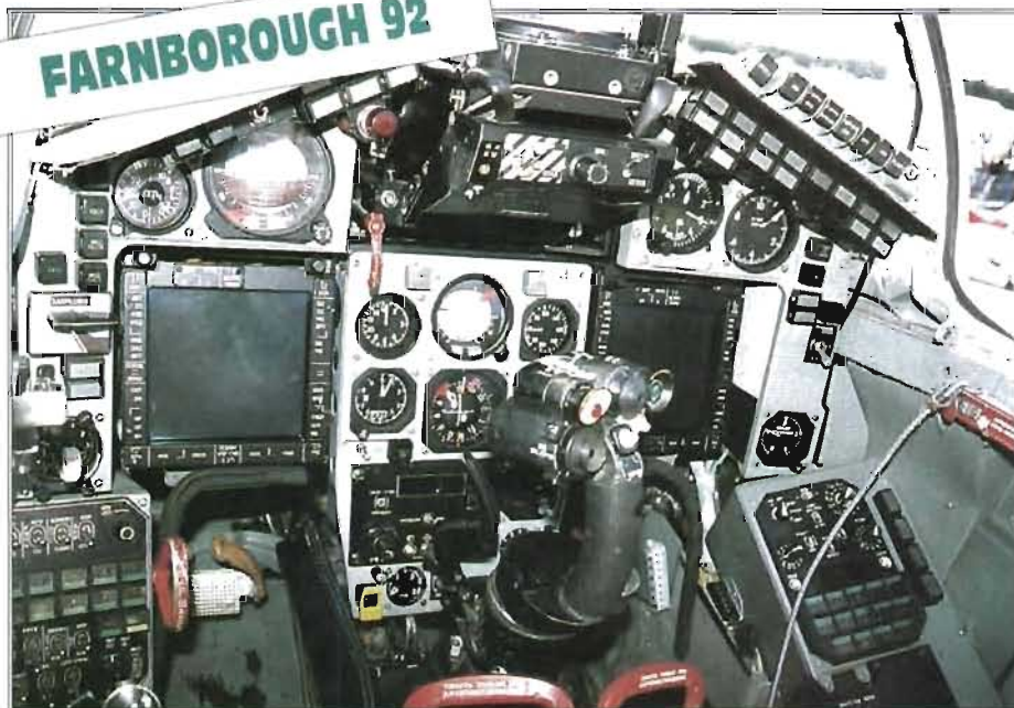
Interiörbild från MiG-29M:s cockpit. Förarutrymmet har ny instrumentering. Här ses (bl a) två fyrkantiga, identiska monitorer med elektronisk presentation = radar- och navigeringsinformation. – Foto: Ulf Hugo.
