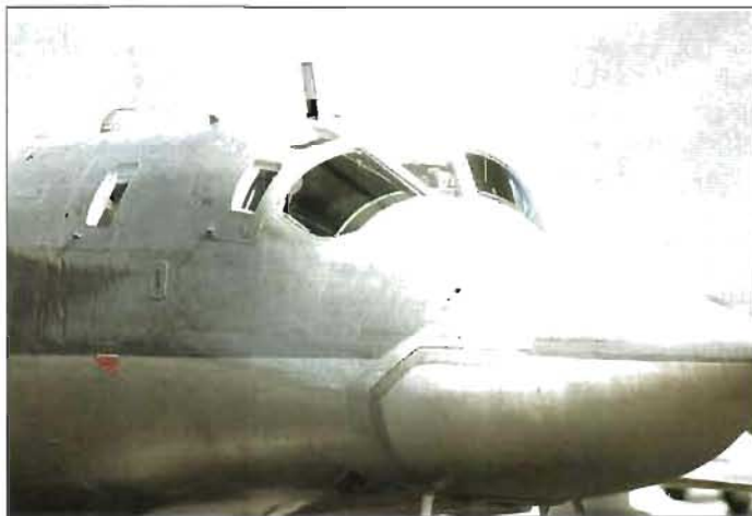
◀ Också ny för västupbliken – Tu-22M3 BACKFIRE C. Kan i ex bära 96 facklor/remspatroner. Har nu också fått robotskottvarnare, som syns som en rund "hatt" på kroppsoversidan. – Foto: Ulf Hugo.
