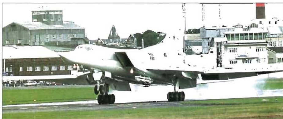
◀ Också ny för västupbliken – Tu-22M3 BACKFIRE C. Kan i ex bära 96 facklor/remspatroner. Har nu också fått robotskottvarnare, som syns som en rund "hatt" på kroppsoversidan. – Foto: Ulf Hugo.
