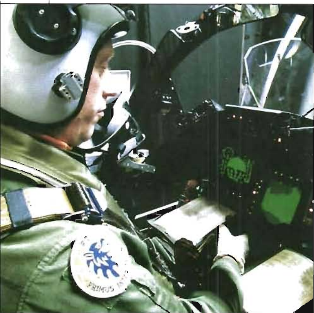
F 7-pilot i Gripen-simulator för verifierande simulering av 39-systemet.
