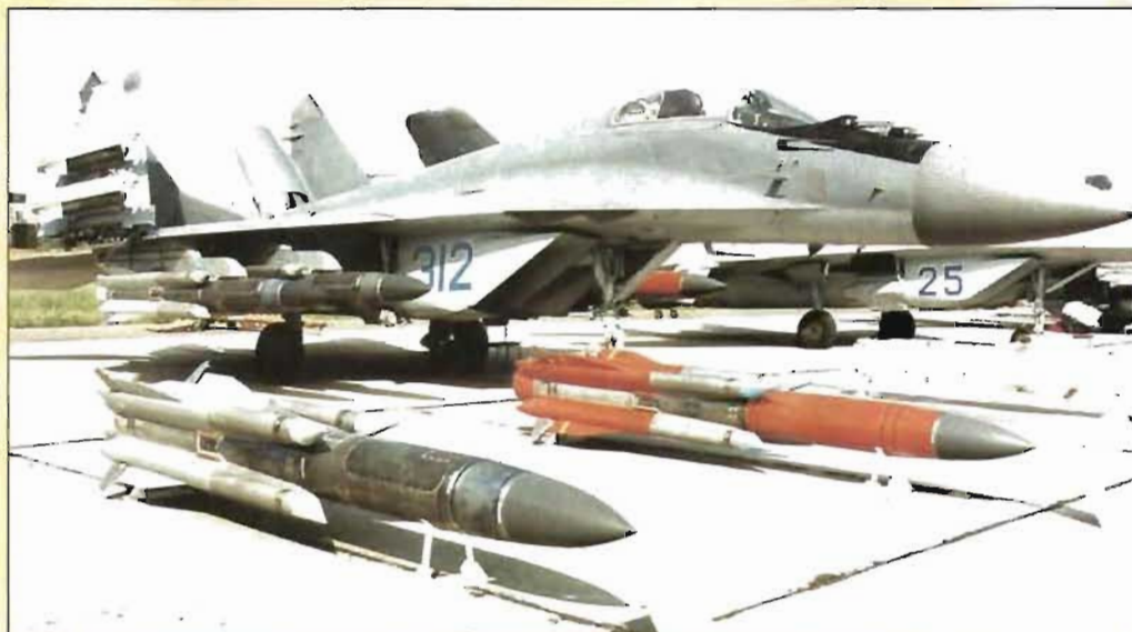
Ovan: Framför MiG-29K ligger bägge versionerna av AS-17 – närmast den signalsökande (Ch-31P) och 1 h versionen med aktiv radarmålsökare (Ch-31A). Östsidans första taktiska sjömålsrobot.
