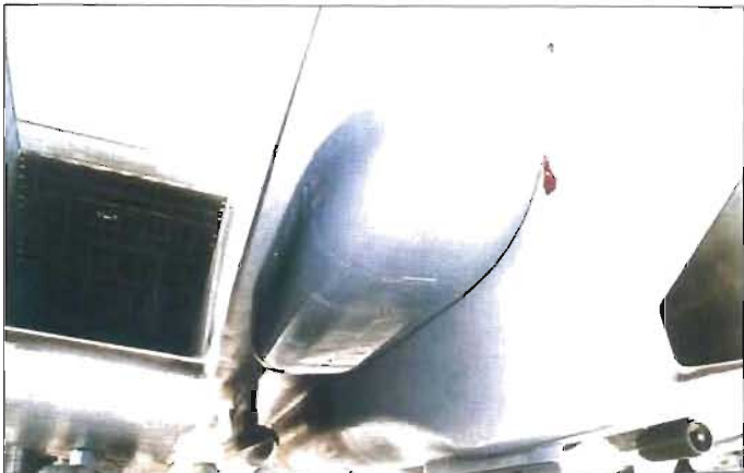
Utbyggnad mellan luftintagen för extraavionik till Su-30MK.
