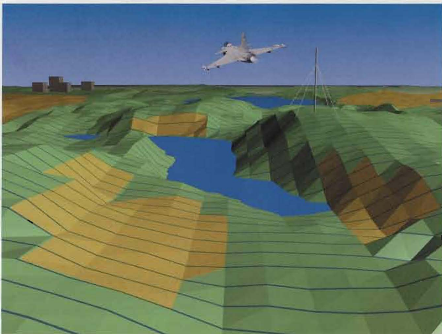
Terrängdatabasen innehåller 200 miljoner punkter med 50 meters mellanrum. Flyghinderdatabasen innehåller 5000 hinder som är över 40 meter. Markanvändningsdatabasen innehåller 14 typer av vegetation.
