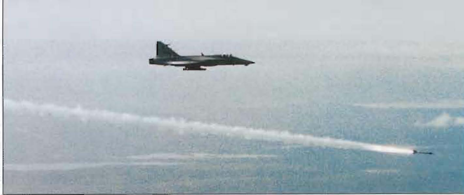
JAS 39 Gripen under skjutprov med jaktroboten Sidewinder (Rb 74). IR-robot utan svängprestanda.
