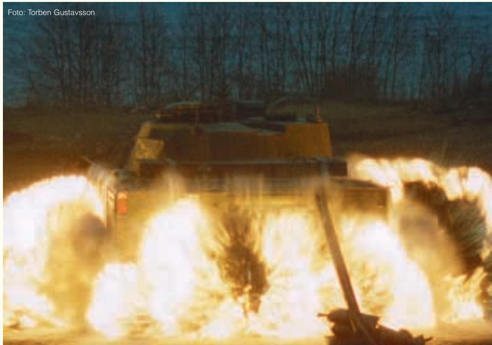
Sprängning med en referensmina under ett Strf 90 vid FMV:s provplats i Karlsborg.
