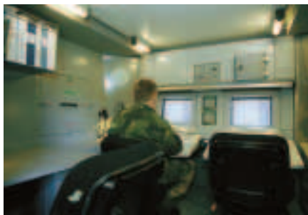
Underrättelseenhet 23 är tänkt att manövreras av en underrättelseledare och ett radarbefäl. En tredje operatörsplats finns tillgänglig för exempelvis en ytmålschef. Samtlig personal sitter splitterskyddat.
