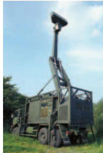
UndE23 har luftvärnets första 3D-spaningsradar, vilket innebär att systemet kan detektera såväl avstånd, riktning som höjd hos målet.
