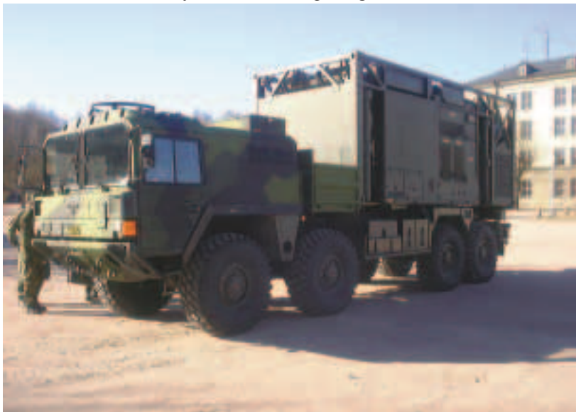
Den UndE23-prototyp som hittills levererats till FMV är baserad på en Scania-lastbil, men när den riktiga leveransen kommer igång kommer man att använda sig av MAN-lastbilar (bilden), då dessa har väsentligt bättre terrägenskaper.
