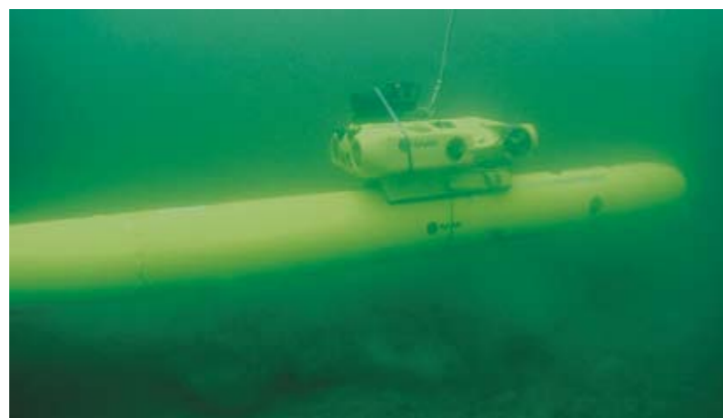
Sapphires kan sjösättas från en ubåts torpedtub. Efter avslutat uppdrag griper en fjärrstyrd farkost tag om AUVn och för tillbaka den in i torpedtuben.
