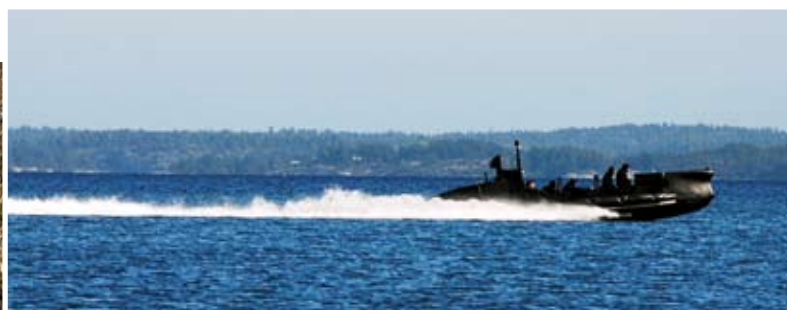
Dykgruppbåten kan ta upp till sex dykare och färdas i tre olika lägen, ytläge, mellanläge och undervattensläge. Bilderna visar de två första varianterna.
