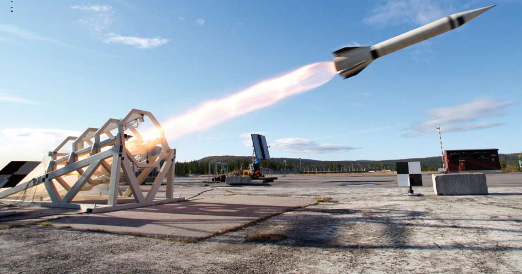
Provskjutning av demonstratorn Hyper velocity missile vid FMV:s provplats i Vidsel för att studera flygning i hypersonisk fart. Roboten nådde toppfarten över Mach 5,5, vilket motsvarar 6 600 km per timme.
