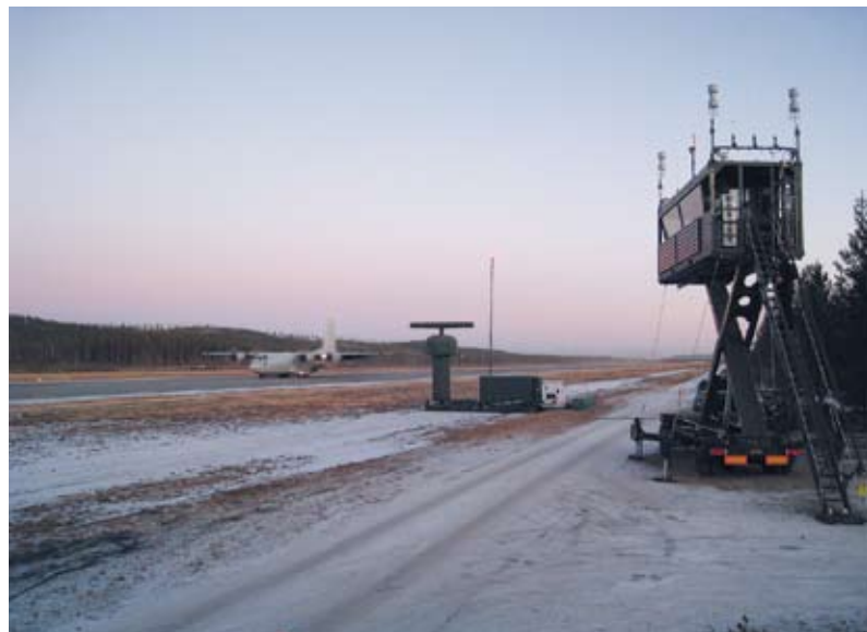
Det mobila trafikledartornet består av en container som är försedd med en lyftanordning.
