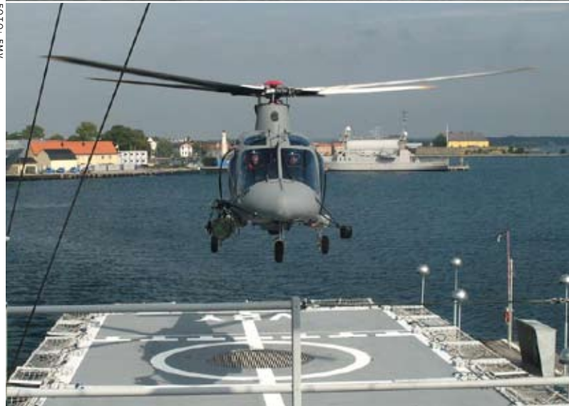
Proven med landningarna på HMS Visby genomfördes både i hamnen i Karlskrona och till havs. FMV T&E höll i testerna på uppdrag av FMVs projekt Visby och projekt Helikopter 15.
