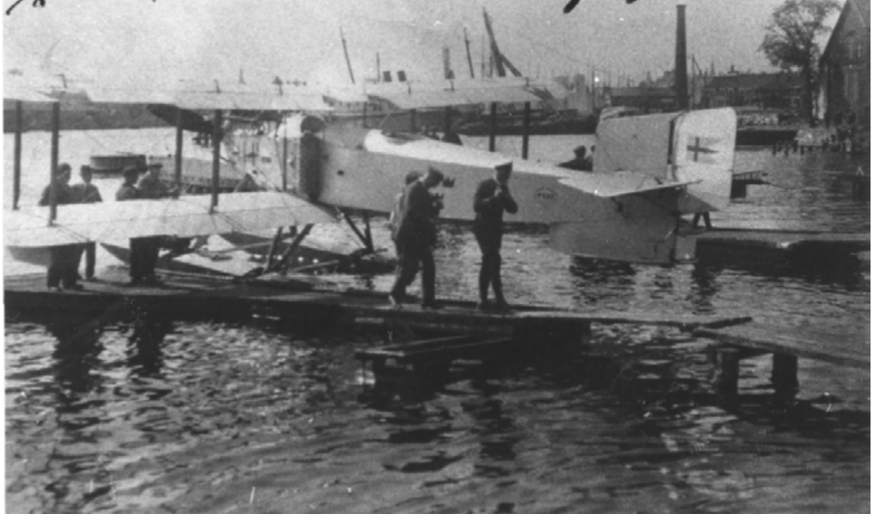
Fairey III D på flottörer, flygbåt nr 30, vid brygga efter flygning Southampton - Stockholm den 16-17 juni 1924 med Arvid Flory som pilot och ingenjör Falke som spanare. Planet hade en 360 hp Rolls Royce Eagle IX,.
