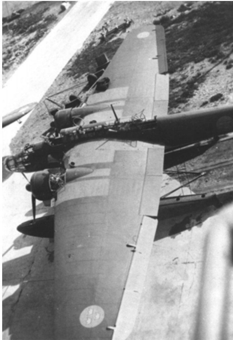
T 2, Heinkel He 115 fotograferad snett ovanifrån, från taket på hangar 81. Vingyta 87,05 m 2 , Spännvidd 22,275 m, längd 17,3 m.
