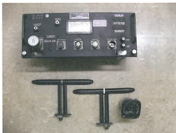
Radarhöjdmätare AN/APN-1 (svensk beteckning PH-10/A) med instrument och "cigarrantennor". Denna typ av höjdmätare anskaffades tidigt på 1940-talet och kan ha varit den utrustning som användes vid de första radarförsöken på Bromma.
