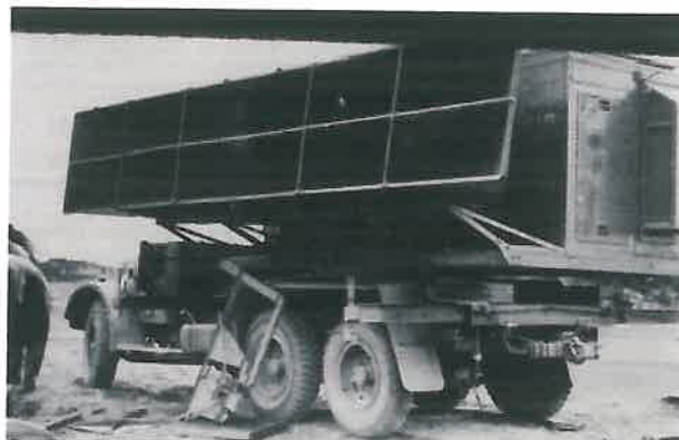
I den engelska spanings- och jaktstridsledningsradarstationen AMES 21, som inköptes till Sverige 1950, ingick denna spaningsradar typ AMES 14, den fick senare den svenska beteckningen PS-14. Fordonet är inte krockskadat utan var av den "öppna typ" som bilden visar. Hornantennen byttes senare ut mot en parabolisk cylinderreflektor.
