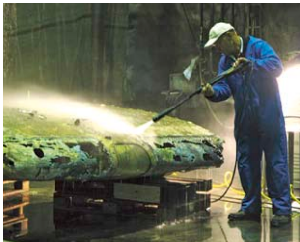
Det var väldigt viktigt att få bort smuts och saltvatten från DC-3:an innan korrosionsskyddsmedlet applicerades. Här ses Thure Svensson tvätta flygplanets högra ving.
